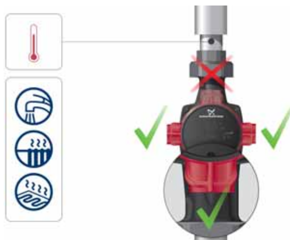
3. ilustr. Vadības skapja novietojuma varianti apkures un māsaimniecību karstā ūdens apgādes sistēmās
