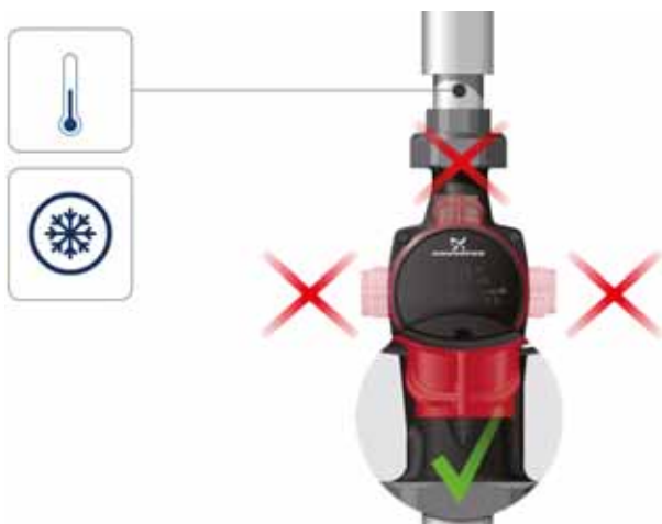
4. ilustr. Vadības skapja novietojums, gaisa kondicionēšanas un aukstā ūdens sistēmās
